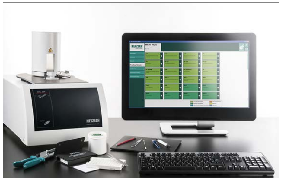
Bild 1: Netzsch DSC 214 Polyma mit zugehörigem Probenvorbereitungssset.
