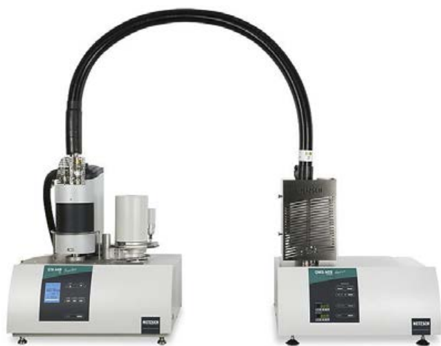
1 NETZSCH STA 449 F1 Jupiter® coupled to a QMS 403 Aëolos®
